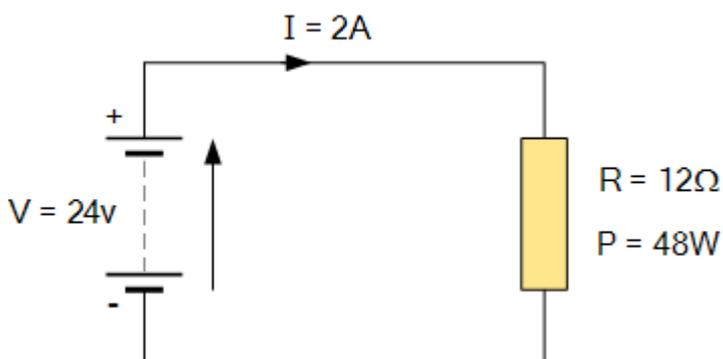
Voltage [  $V = I \times R$  ] =  $2 \times 12\Omega = 24V$
